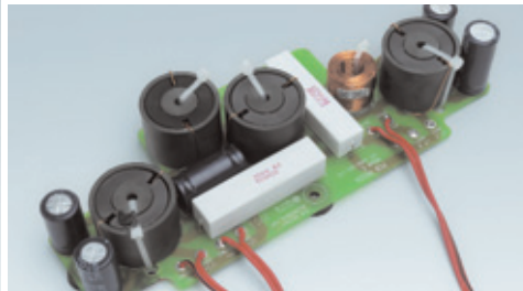
ACE-Technologie für besseren Bass (oben) Frequenzweiche (unten)
